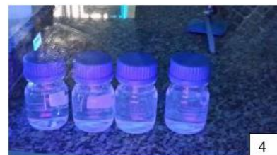
FIGURA 2- Aspectos do Laboratório de análise de água da CAGEPA (Patos-PB) onde foram analisadas as amostras coletadas. FIGURAS 3 e 4 - Resultados do método cromofluorogênico com ausência de Coliformes Totais e do teste de fluorescência (luz azul) indicando ausência por Escherichia coli . Fonte: Dados dos Autores, 2016.
